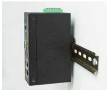
DINレールの取り付け
