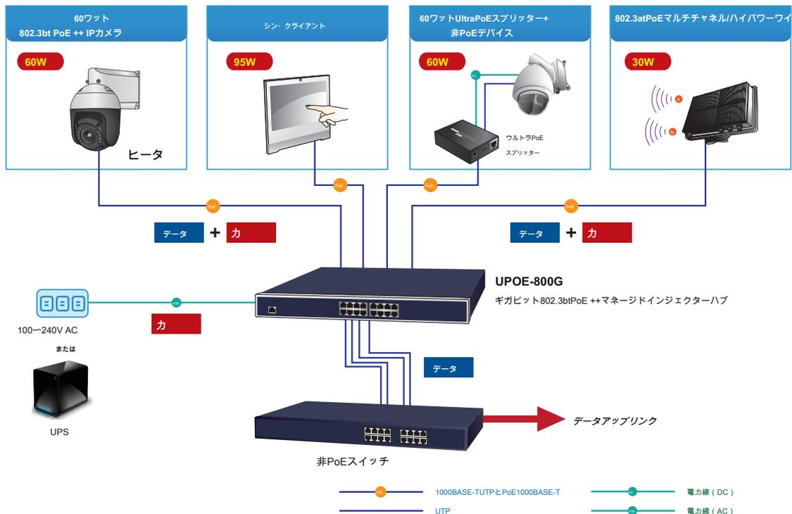
UPOE-800Gは、1つのユニットからのデータとPower over Ethernetにより、電源ケーブルの配置を減らし、壁、天井、または手の届かない場所に専用のコンセントを設置する必要をなくします。
